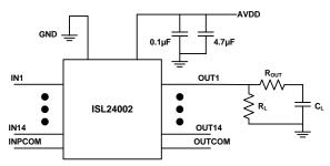
FIGURE 1. TEST CIRCUIT
